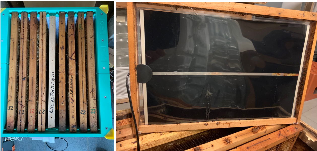
La configurazione dell'arnia durante l'esperimento. Il riscaldamento è al centro, i sensori del termostato e del datalogger sono situati a destra del riscaldamento, inframmezzati da un favo costruito. A destra, il riscaldamento per terrari, potenza 33-34W, montato in un telaio.
